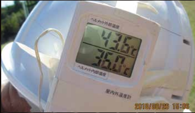
炎天下ひたすら歩き、ヘルメット内部温度を計測する。
